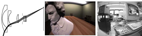
Abbildung 3.6: Auf der linken Seite sehen wir den schematischen Aufbau eines 16mm-Fischaugenobjektivs. Der Strahlengang von stark am Abbildungsrand liegenden Lichtstrahlen ist eingezeichnet. Er ergibt sich aus Form und Brechungseigenschaft der jeweiligen Linse innerhalb des Objektivs. In der Mitte sehen wir das simulierte Ergebnis. Die tonnenförmige Verzeichnung ist vor allem an der Decke sehr gut zu erkennen. Das Bild auf der rechten Seite ist eine reale Aufnahme mit deutlich sichtbarer tonnenförmiger Verzeichnung. Links/ Mitte: [Kolb et al., 1995], Rechts: [Swaminathan und Nayar, 2000]
