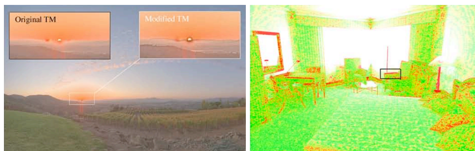
Abbildung 5.11: Die Abbildung zeigt links den Fehler, der entsteht, wenn man zuerst das Differenzbild JPEG komprimiert und anschließend das geänderte HDR tonemappt (rechts oben). Das LDR ist in diesem Fall fehlerbehafteter. Auf der rechten Seite ist eine Metrik visualisiert, die angibt, welche Fehler zu mehr als 75% Wahrscheinlichkeit anders als das Original wahrgenommen werden (Rot stellt den stärksten Fehler dar). Nicht das LDR hat in diesem Fall zusätzliche Fehler sondern das HDRI. [ Ward und Simmons, 2004 ]
