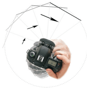
Abbildung 3.8: Die Abbildung zeigt die Aufnahme eines Panoramas mithilfe einer um das optische Zentrum des Objektivs rotierten Kamera. [reallyrightstuff.com]
