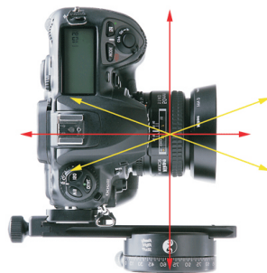
Abbildung 3.9: Eine solche Vorrichtung kann benutzt werden, um die Kamera genau am optischen Zentrum der Linse zu drehen. Dadurch entstehen keine Parallaxeeffekte in der fertigen Aufnahme (vergleiche Abschnitt 3.3.2.5 ). [reallyrightstuff.com]
