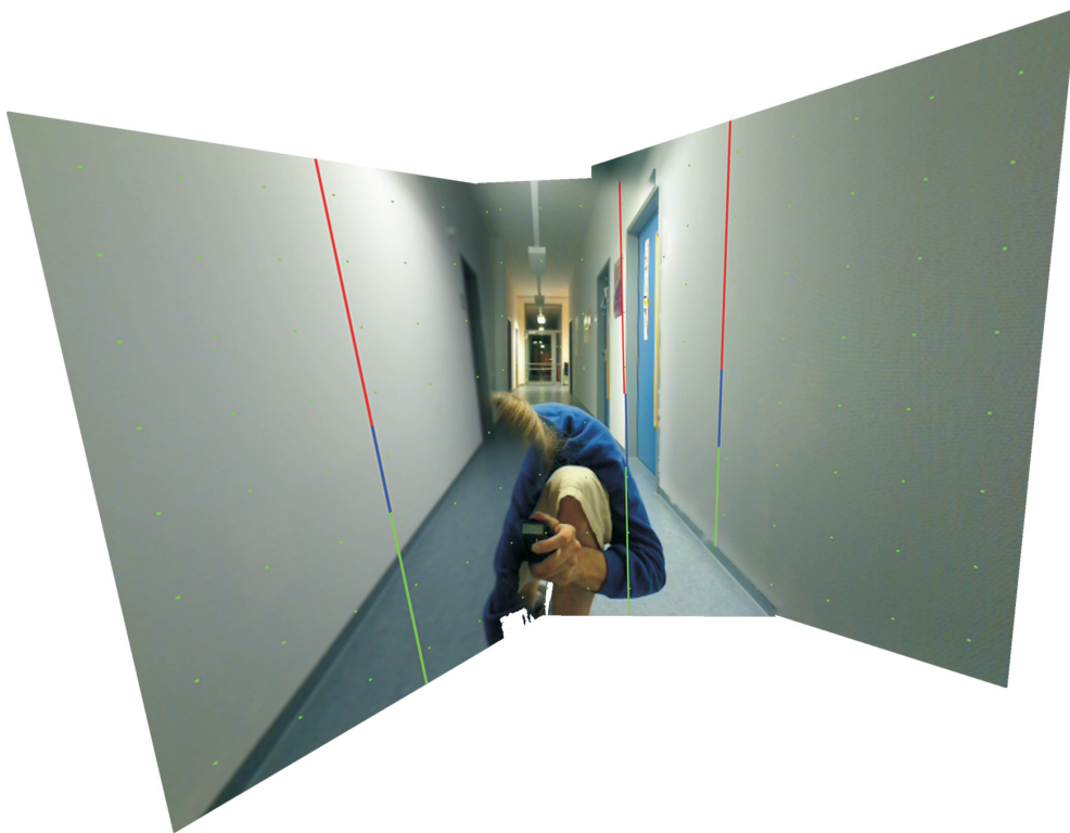
Abbildung 6.2: Die Flurszene wurde mit den Anordnungen auf der vorigen Seite aufgenommen. Wir sehen „Geister“ (vergleiche Abschnitt 2.4.2). Die bunten Striche sind der nicht abgeschaltete Debugoutput (vergleiche Abbildung 5.20).
