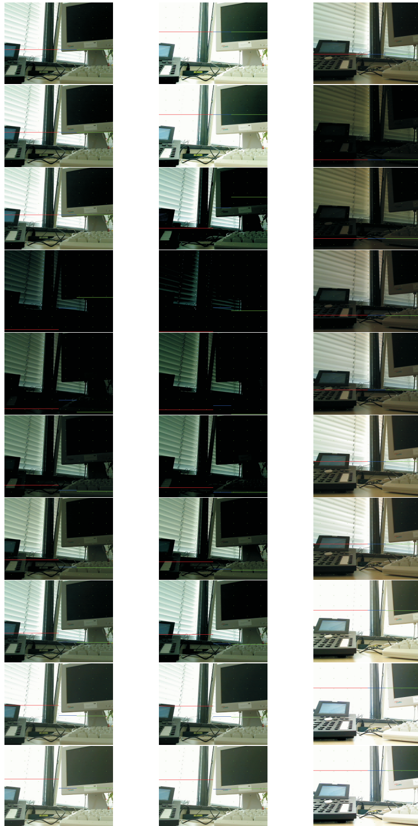
Abbildung 5.19: Links: Zwei Belichtungsreihen, die entstehen, wenn man die Kamera anweist, die nächste Belichtung einzustellen und sofort die nächste Aufnahme zu machen, sobald ein Sample gespeichert ist. Rechts: Diese (erwünschte) Reihe entsteht, wenn der BÄD eingeschaltet ist. Bei den obersten Bildern ist jeweils die Belichtungsautomatik aktiviert. Nach unten folgen die Belichtungsstufen \frac{1}{500} , \frac{1}{250} , \frac{1}{125} , \frac{1}{63} , \frac{1}{31} , \frac{1}{16} , \frac{1}{8} , \frac{1}{5} , \frac{1}{5} .
