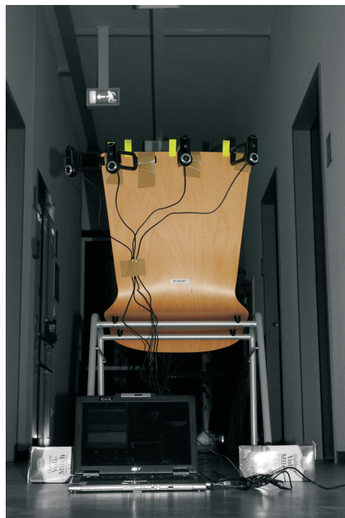
Abbildung 6.1: Das Bild zeigt den, an einem Stuhl befestigten, Testaufbau mit vier Kameras und einem Laptop. Die Kameras sind hochkant montiert, damit eine größere vertikale Auflösung (1600 Pixel) erreicht wird.
