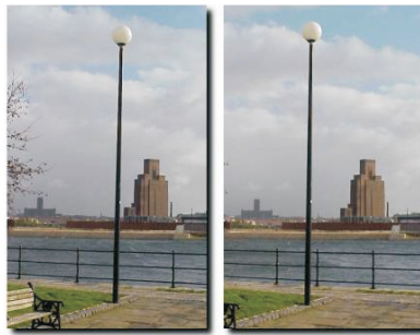
Abbildung 3.16: Zwischen den beiden Aufnahmen wurde das optische Zentrum der Kamera verschoben. Dadurch tritt vor allem in der Nähe Parallaxe auf. An der relativen Position der Lampe zum Gelände und den Gebäuden im Hintergrund wird dies deutlich. [astro.livjm.ac.uk]
